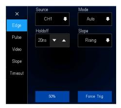
Figure 9.2 Edge trigger menu
